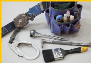
常に身につけている安全帯と腰袋。足場を組む際に使うラチェットレンチやボール等が入っている
